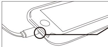
製品下部のmicroUSB充電口に付属の充電ケーブルを差込み、
